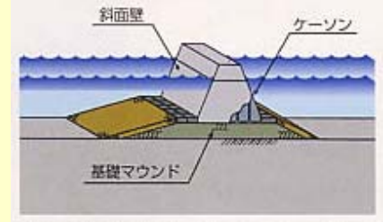
幅広台形ケーソン堤 (大水深部, 高波浪, 軟弱地盤海域で適用)
